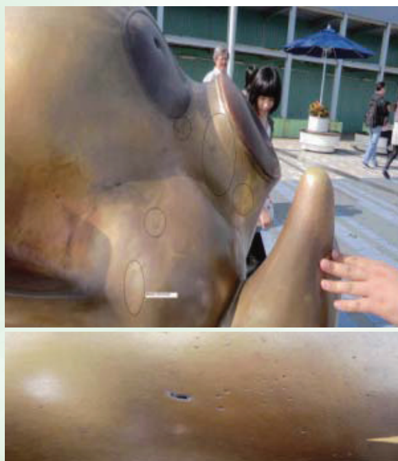
圖6 最大 2mm x 4mm 的小孔
